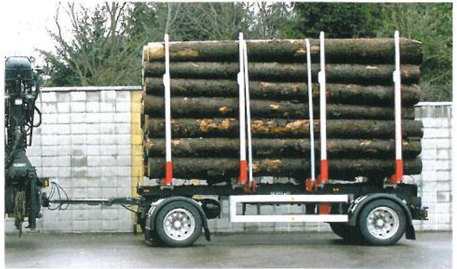
Ausreichende Ladungssicherung von 5m langem Holz – aus langjähriger Praxiserfahrung.
