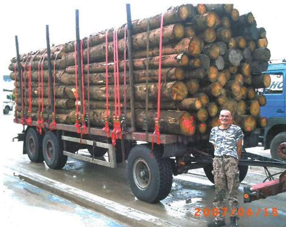
Das Bild trägt, der Fahrer macht nur gute Miene zum bösen Spiel, nachdem ein Polizeibeamter seinen Zug stilllegte und das Anbringen von 24 Spanngurten zur Weiterfahrt gefordert wurde.
